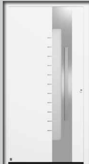
Motief 560 Roestvrijstalen handgreep HOE 600, roestvrijstalen applicatie, motiefglas mat met 11 heldere stroken, 3-voudig thermisch isolerend glas, U_D -waarde tot 0,9 \text{ W}/(\text{m}^2\cdot\text{K})^*
